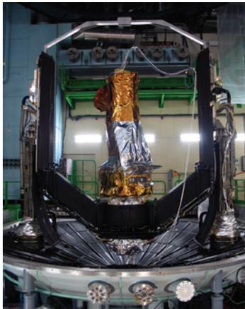
TEST THERMIQUE d'un satellite, dans une cuve à vide. / Satellite thermal test in a vacuum chamber.
