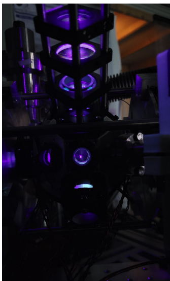
Pièce magnéto optique d'ytterbium, au centre de la chambre à vide de l'instrument ROYMAGE
